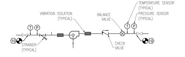
TYPICAL PUMP INSTALL DETAIL SCALE: N.T.S.
